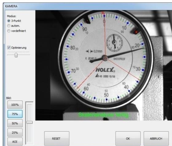
Der erste Punkt muss in der Nähe des Null-Punktes liegen. Die 3 Punkte markieren einen Kreis oder Kreisbogen, der alle Teilstriche schneidet. Für eine funktionierende Ablesung darf der Kreis aber **nicht** größer als die Zeigerlänge sein! Hilfreich ist dabei die Optimierungsfunktion, die den Kreis im allgemeinen optimal anpasst. Über den Schieberegler kann der gewünschte Durchmesser vorgegeben werden.
